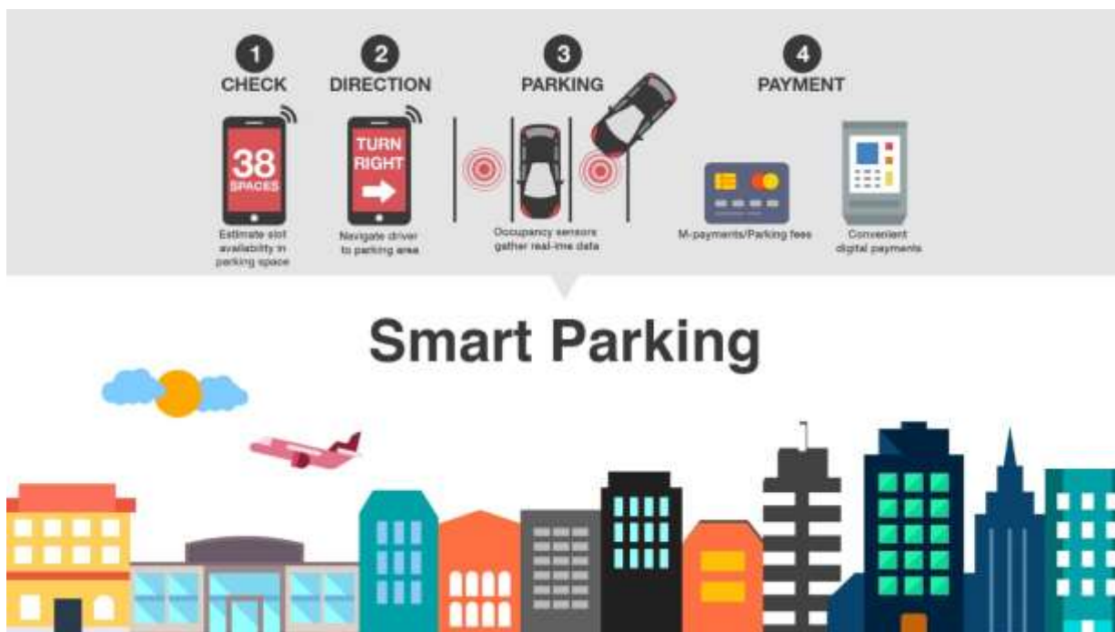
Figura 46. Exemplo do funcionamento do sistema Smart Parking através de sensores
